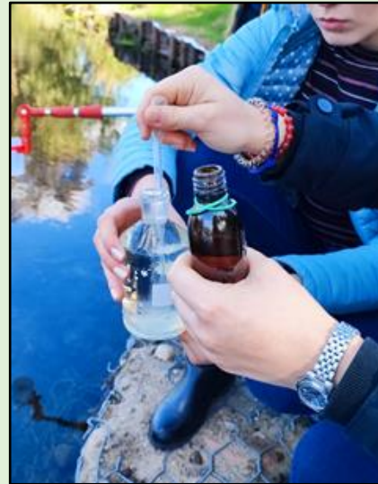
Messstelle 4: Wasserprobe für den Sauerstoffgehalt nach Winkler vorbereiten
